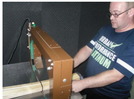
6. Für den besseren Transport werden die Rollroste nun zusammengerollt (daher der Name) und in einer Bündelmaschine mit einem Kunststoffband umwickelt.
