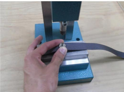
1. Zunächst werden die beigeestellten Gurtbänder mit Druckknöpfen versehen, damit man die fertigen Rollroste im Wohnmobil befestigen kann.
