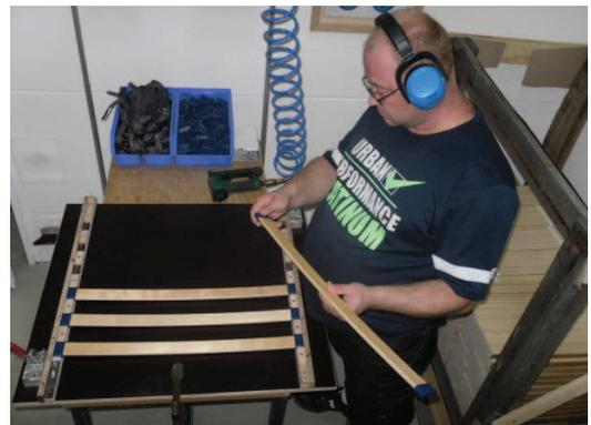
2. Jetzt werden die Federleisten aus Birkenholz mit einer blauen Steckkappe versehen und in eine Hilfsvorrichtung gelegt. Mit dieser wird die Einhaltung aller maßlichen Vorgaben sichergestellt.
