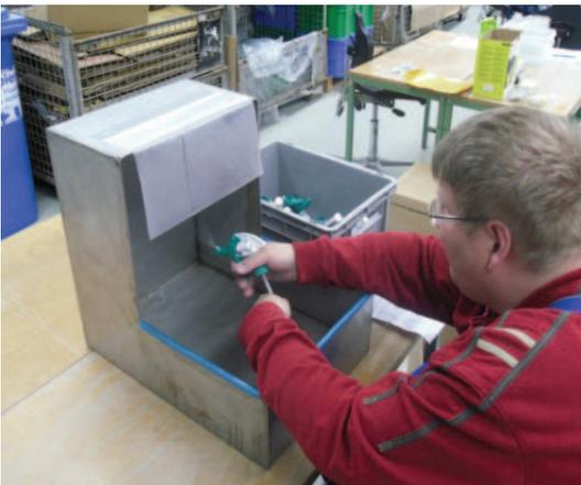
5. Jeder montierte Sprüher wird auf Dichtheit und das richtige Sprühbild geprüft
