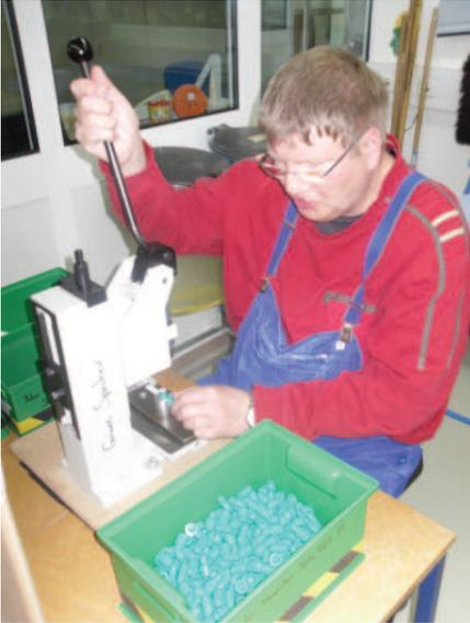
3. Das Ventil mit O-Ring und Kugel wird in die Verlängerung gepresst. Danach wird die Düsenmutter angebracht
