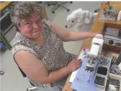
Die Montage eines Scherkopfes für eine Schafschermaschine fordert von Erika Zgoll viel Geschick. Abschluss der Montage ist die Funktionsprüfung mit der Montagevorrichtung. Die Beschäftigten werden von den Fachkräften mit viel Geduld über einen langen Zeitraum eingearbeitet und bei der Produktion ständig begleitet.
