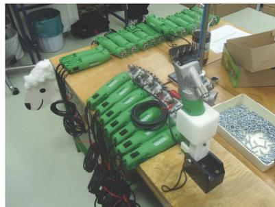
Scherkopf und Antrieb werden zusammen gebaut. Alle Schrauben der Schermaschine werden mit eingestellten Drehmoment-Schraubern angezogen. Nach den Vorgaben des Kunden gibt es zusätzlich noch eine Überprüfung der Verschraubung mit einem geeichten Drehmomentschlüssel.
