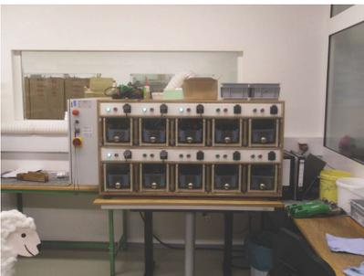
Der Prüfkasten verfügt über ein für jeden Schermaschinentyp einstellbares Prüfprogramm. Jede Maschine wird geprüft, danach wird das Ergebnis gespeichert und die Maschine bekommt einen Aufkleber mit einigen technischen Daten und einer Seriennummer. Dadurch ist die Montage zurück verfolgbar, die Chargennummer der Einzelteile sowie auch die Funktionsprüfung sind dokumentiert.
