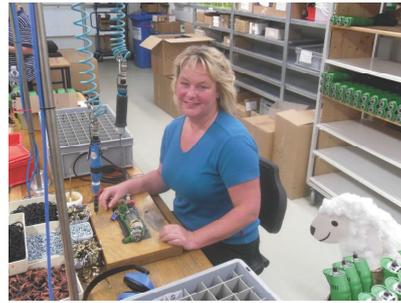
Birgit Bönisch bei der Montage des Antriebes für die Schafschermaschine. Über 70 verschiedene Teile werden je nach Typ verbaut. Die Fachkräfte Fr. Binder und Fr. Bönisch verwalten das Lager und bestellen beim Erreichen des Mindestlagerbestandes neue Rohware.
