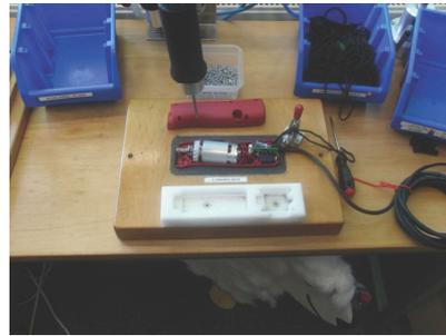
An diesem Arbeitsplatz für Rodeo Pferdeschermaschinen wird der fertig montierte Antrieb mit dem Gehäuse verbaut. Vorgabe für diese, wie für alle anderen Tätigkeiten, ist ein Arbeitsplan, der in Zusammenarbeit der Fachkräfte mit dem Kunden erstellt wurde.
