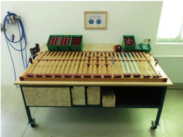
Die neuen maßgefertigten Arbeitstische. Wenn der Tisch mit den Federleisten voll bestückt ist, können 28 Lattenroste produziert werden. Alle Tische sind fahrbar und für verschiedene Typen verwendbar.
