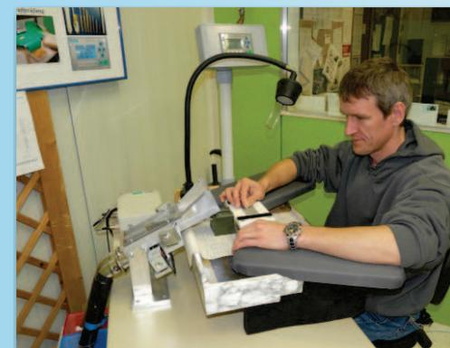
Zu den aufwändig konstruierten Geräten zählt die „Zugkraft-Prüfvorrichtung“ für die Firma ODU. Damit prüft Georg Schmeizl Kontakte für Steckverbindungen, welche z.B. in der Medizintechnik eingesetzt werden.
