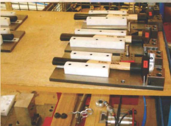
Wechseleinsätze zum Einpressen der unterschiedlichen Schlagwerkzeuge
