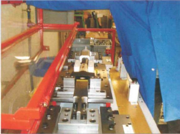
Thomas Bittmann legt Hammerstiel, Hammerkopf und Ringkeil in die pneumatisch angetriebene Sondermaschine ...
