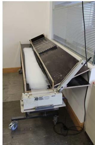
In diese Vorrichtung werden die Stiele zum Bekleben und Verpacken eingelegt
