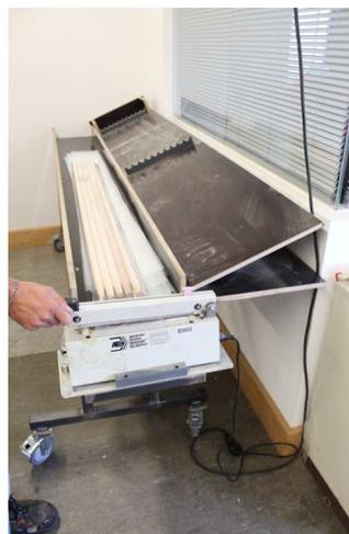
Der bestückte Polybeutel wird für den Versand verschweißt
